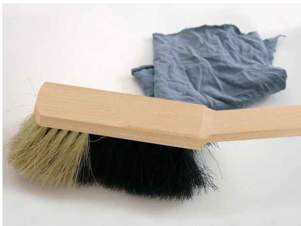
1. Voorbereiden Veeg de SOLITEX WELDANO 3000 schoon met bijv. een doek. Verlijmen op bevroren folies is niet mogelijk. Er mogen geen afstotende stoffen op de folies aanwezig zijn (bijv. vetten of siliconen). Ondergronden moeten voldoende droog en stevig zijn.
